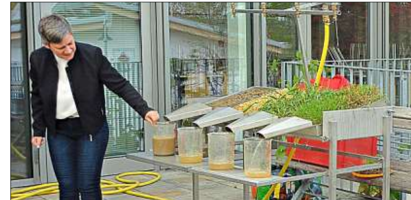
Ruth Brunner vom AELF zeigte mittels eines Regen-Simulators den Oberflächenabfluss nach Regenereignissen auf verschiedenen Böden
