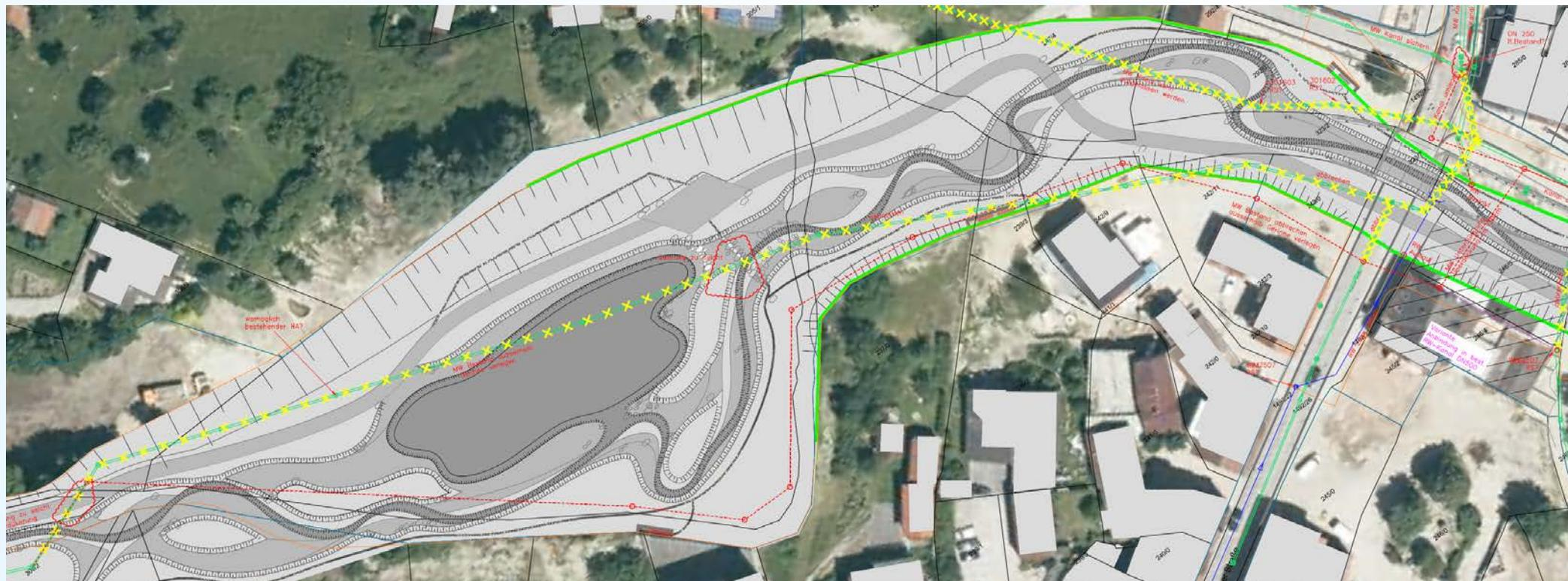
beispielhafter Planausschnitt - aus dem zukünftigen Abflussquerschnitt sind die vorhandenen Sparten (z.B. Abwasserleitung) rückzubauen, bzw. zu verlegen.
